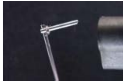
FIGURA 3 - Pequeno rolo de solda de prata inserida na haste menor e o maçarico pronto para a soldagem definitiva.
