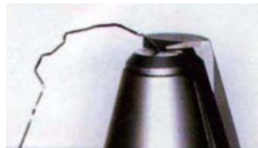
Figura 8. Técnica BAS: Fabricación de alambres linguales individualizados con un robot que dobla los alambres, controlado por un ordenador
